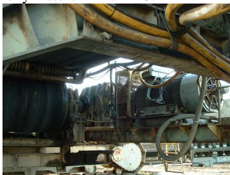
Rys. 1. Widok fragmentu wału napędu taśmy (2,50m x 1,20m):silnik, przekładnia, wał.
