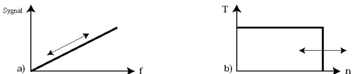
Rys. 4.16 Zależność pomiędzy sygnałem zadawania prędkości i charakterystyką momentu silnika obrotowego silnika.
